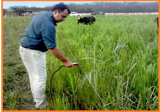
A **parte final da cerca é o ponto crítico** de uma cerca elétrica rural, é onde possivelmente chegue a menor quantidade de energia, em comparação com o ponto inicial perto do eletrificador.
