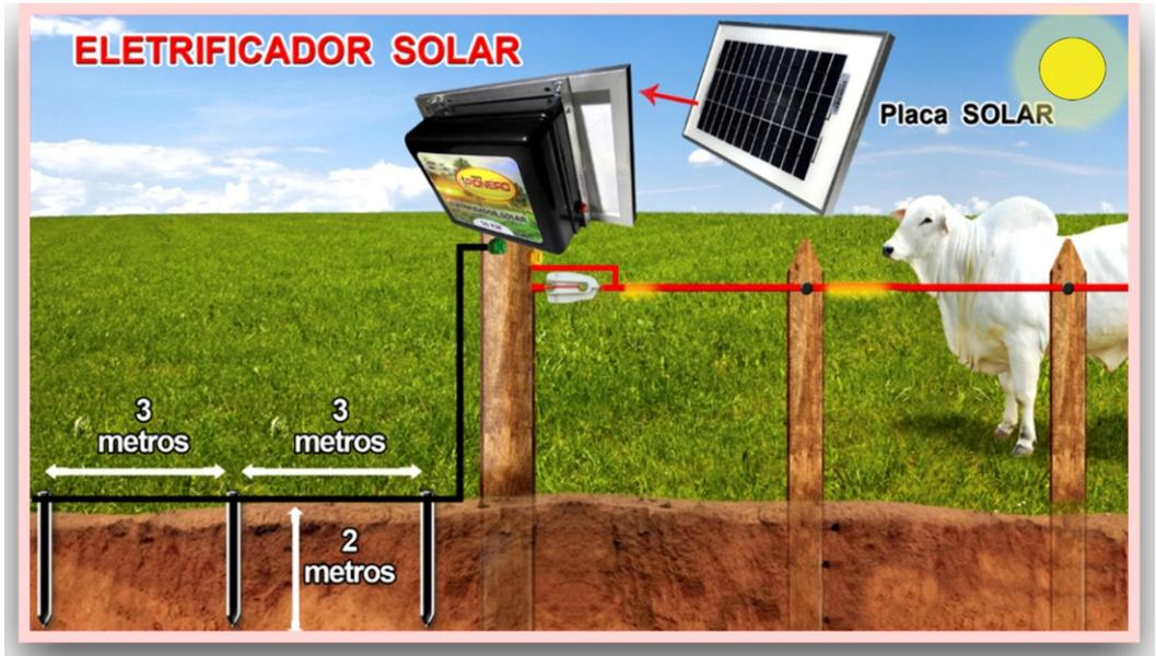
Caso seja utilizado hastes de **aço galvanizado**, utilizar **fio de arame galvanizado** para conexão com o Eletrificador.
